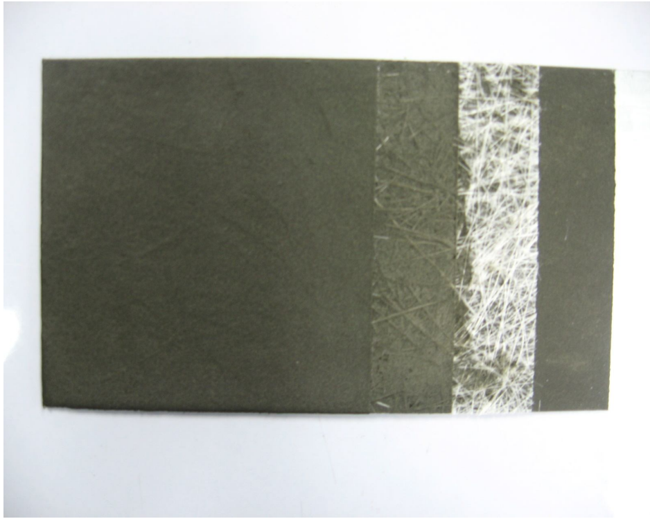
8. ภาพหลังทาด้วย UPBUILDCRETE จำนวน 2 เที่ยว ทิ้งให้แห้ง
